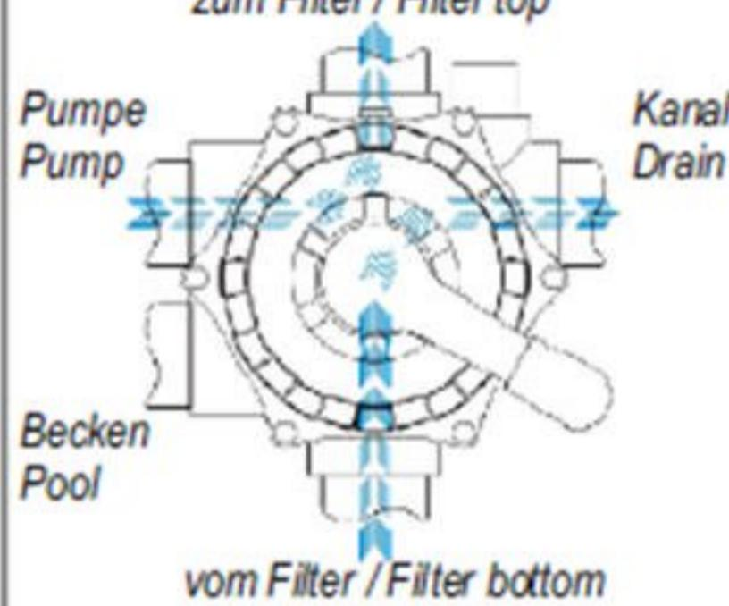
Reinigen des Filtermediums (zB Sand) im Gegenstrom (umgekehrte Durchflußrichtung)
